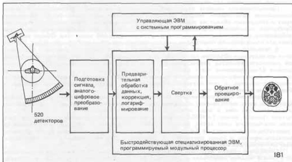
Рис. 181. Принципиальная схема работы компьютерного томографа.
